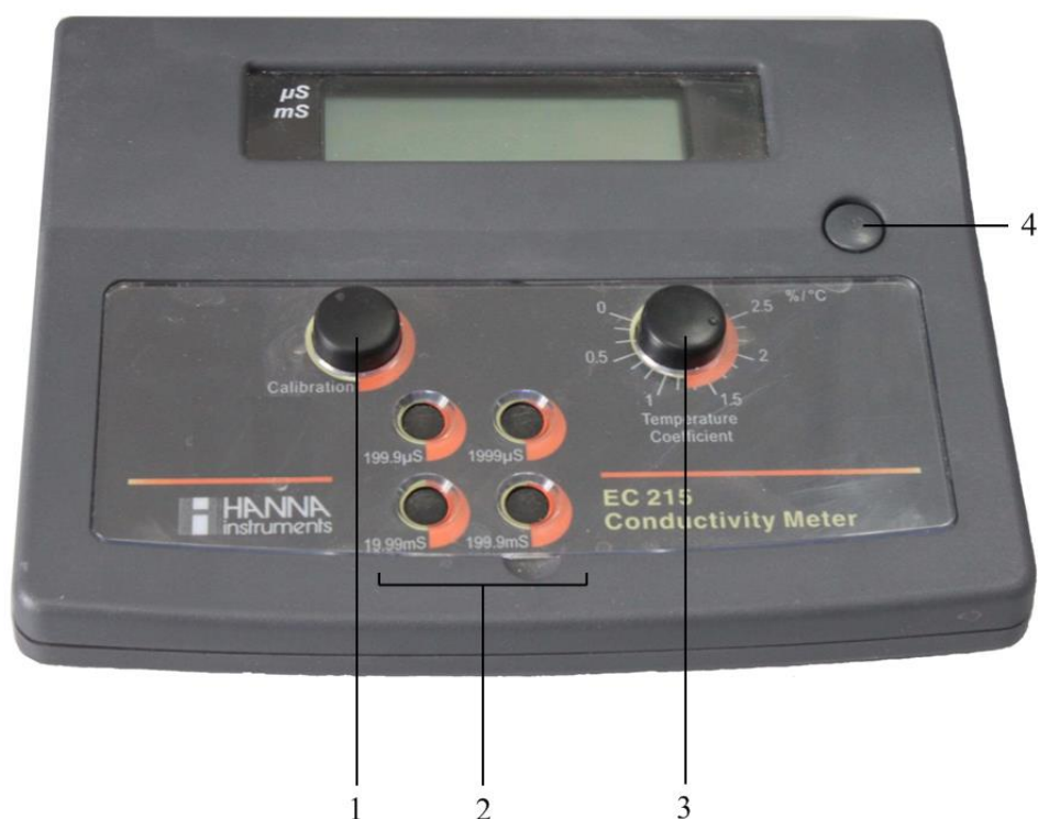
Рис. 1.7. Лицевая панель кондуктометра EC 215. Позиции: 1 – калибровка прибора; 2 – диапазоны измерений \kappa ; 3 – установка температурного коэффициента; 4 – включение / выключение кондуктометра
