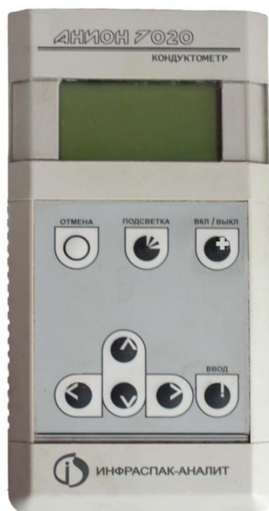
Рис. 1.6. Лицевая панель кондуктометра Анион 7020
