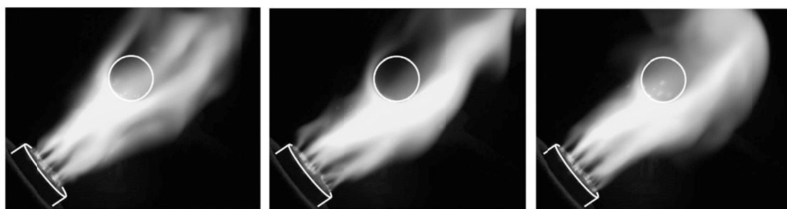
Рисунок 3. Плазменный поток, направленный под углом вверх. Экспозиция 0,2 мс. I = 8 А. l = 6 см. Белыми линиями обозначены контуры торцов катодного узла и анода
