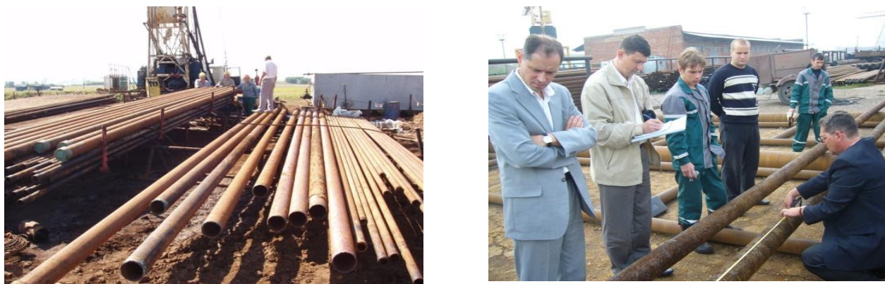
Рис. 1.27. Проведение визуального осмотра обсадных труб
