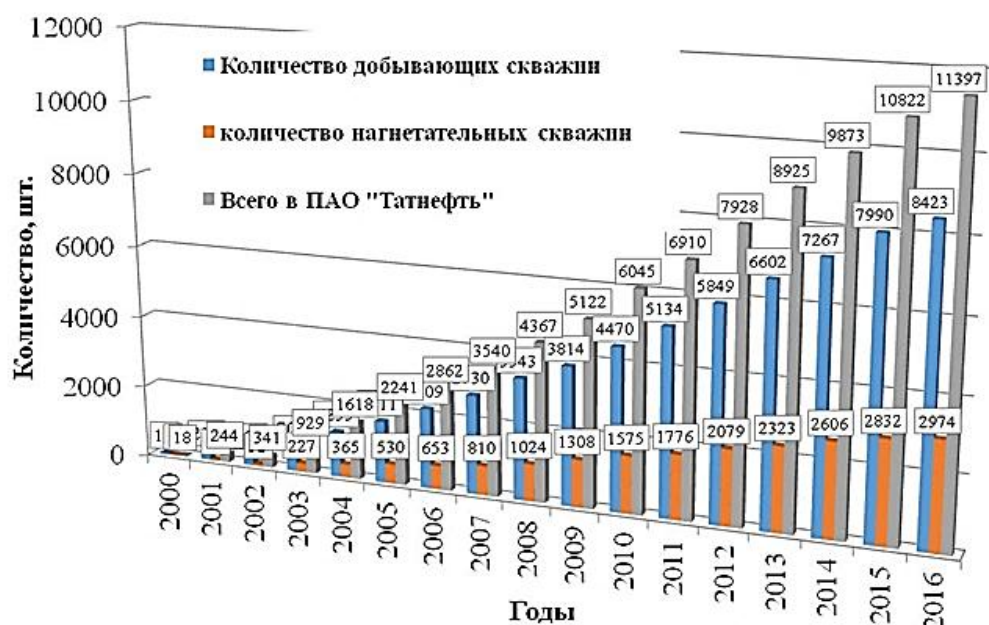
Рис. 1.20. Динамика оснащения скважин катодной защитой на территории ПАО «Татнефть» за период 2000 – 2016 гг.
