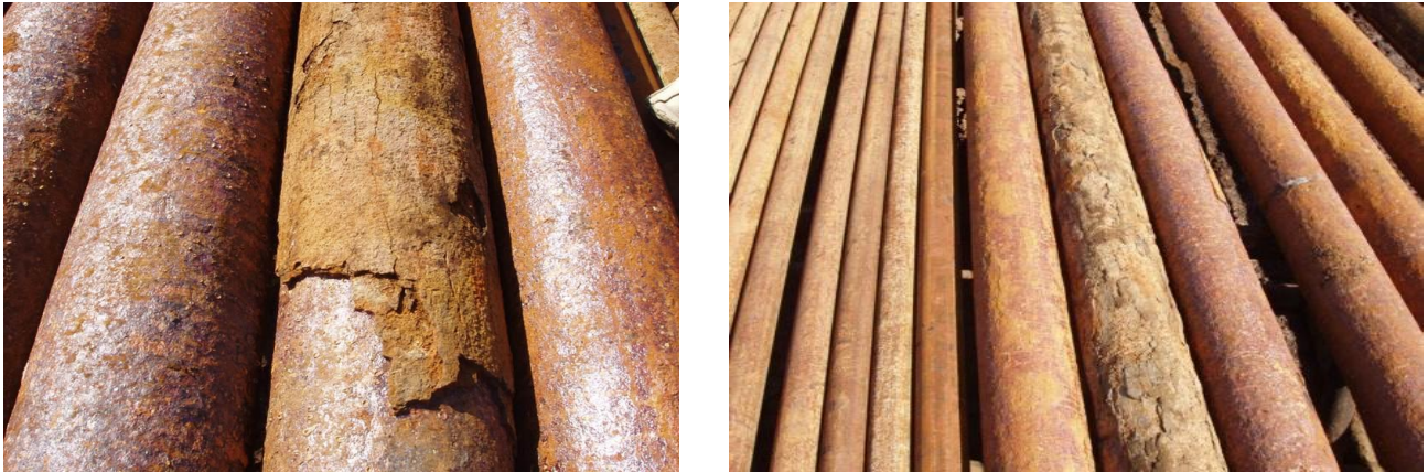
Рис. 1.6. Наружная коррозия обсадной трубы
