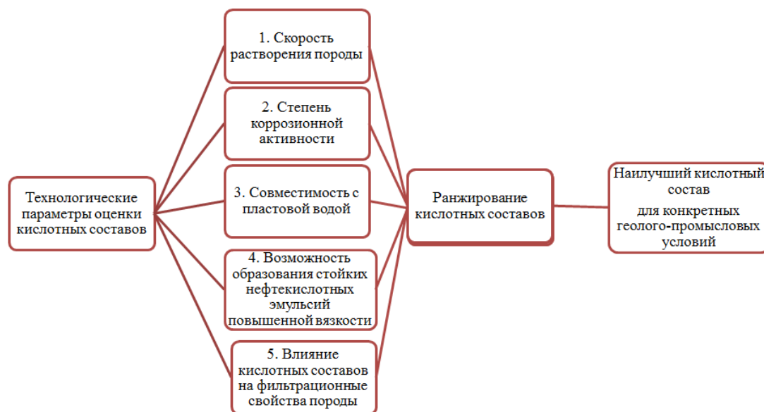
Рисунок 1– Алгоритм подбора оптимальной композиции для увеличения эффективности проведения кислотных обработок призабойной зоны пласта
