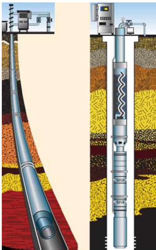
Рис.1 УЭВН с погружным синхронным низкооборотным ЭД
