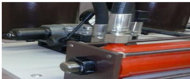
Рис. I.9. Правое положение ручки переключателя гидрораспределителя
