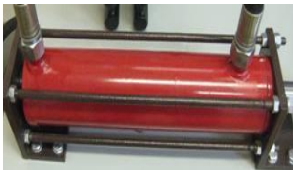
Рис. I.6. Масляный цилиндр Ц2
