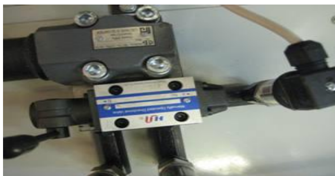
Рис. I.10. Левое положение ручки переключателя гидрораспределителя
