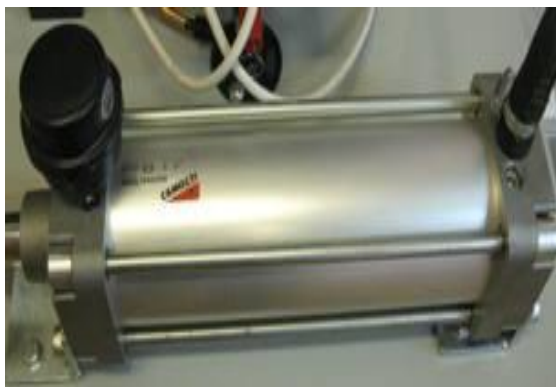
Рис.1.5. Воздушный цилиндр Ц1
