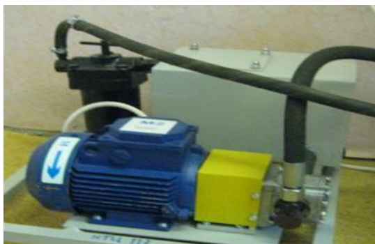
Рис. 1.4. Масляный насос и бак с маслом
