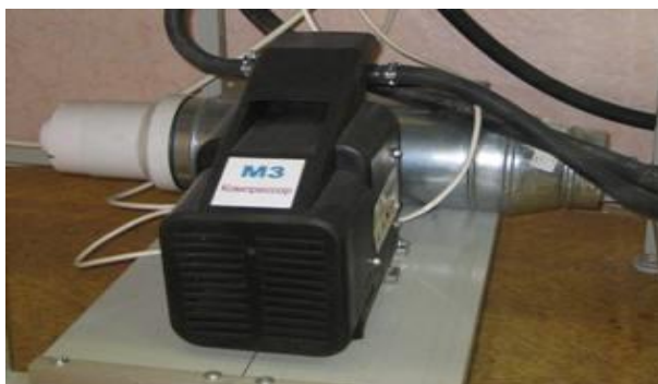
Рис.1.3. Компрессор, используемый для нагнетания воздуха в пневмоаккумуляторы
