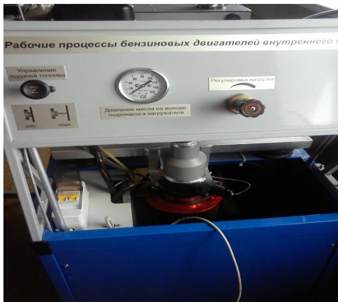
Рис.5.8. Передняя панель стенда с регуляторами числа оборотов, мощности двигателя и манометром
