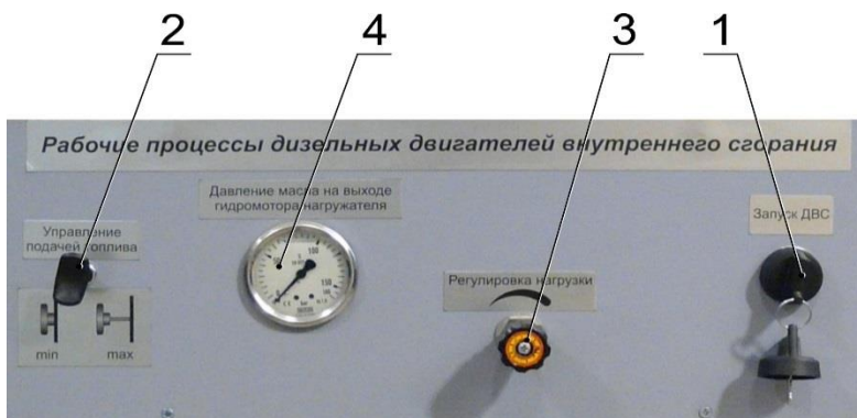
Рис.6.8. Панель управления стендом. 1 – Ключ пуска двигателя; 2 – Модуль управления топливной рейкой; 3 – Модуль управления гидравлическим дросселем; 4– Манометр давления масла нагружающего устройства
