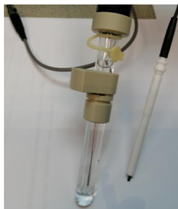
Рис. 1 - Электрод сравнения и сенсорный электрод прибора Multi EA 5100
