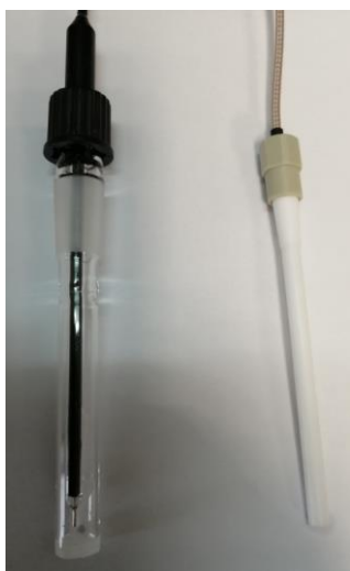
Рис. 2 - Рабочие электроды: слева – платиновый катод, справа – серебряный анод
