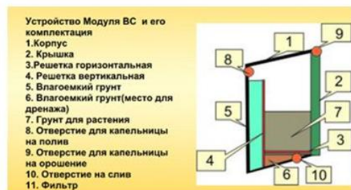
Общий вид контейнера и схема его устройства.
