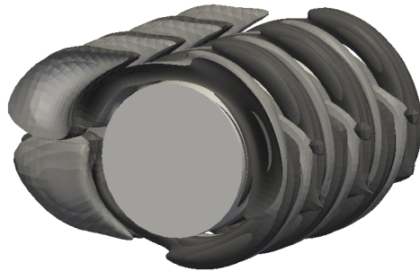
Рис. 1. \beta = 196 , Re = 451 . Трехмерное течение. y -компонента завихренности. \omega_y^{min} = -2.7 , \omega_y^{max} = 2.7
