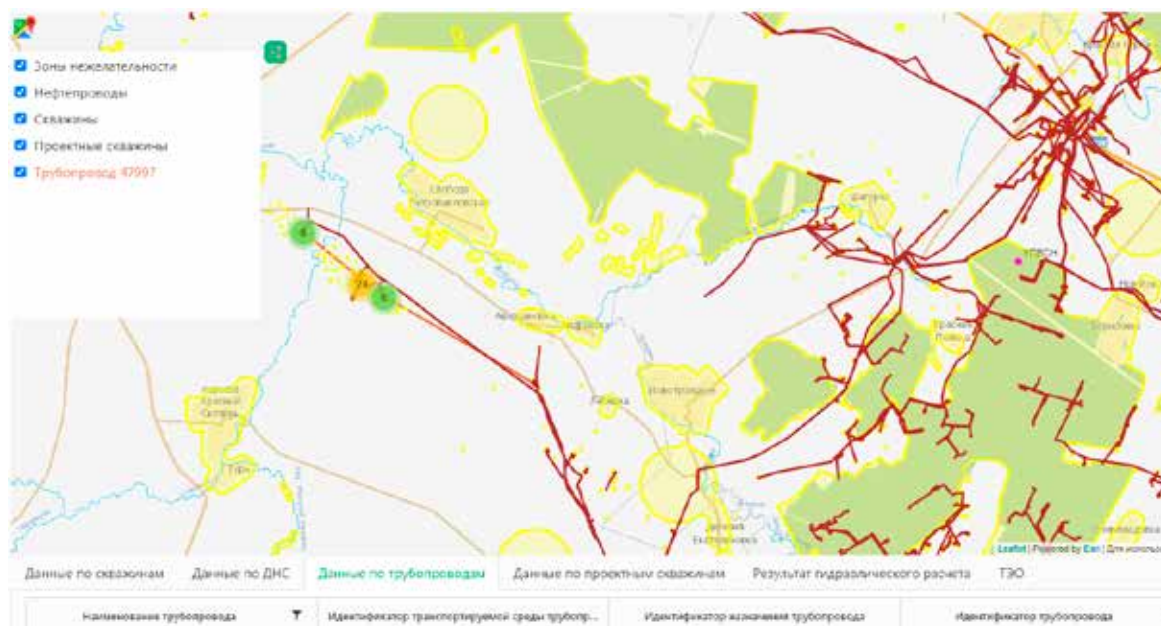
Рис. 4. Автоматически спроектированная трасса трубопроводов
