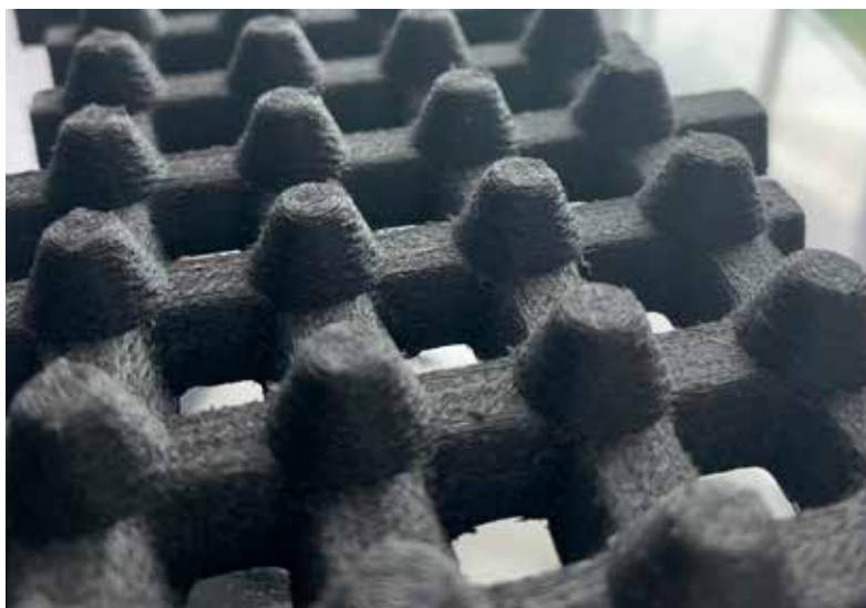
Рис. 6. СТО с высоким показателем шероховатости, не пригодное для изготовления ячеистого заполнителя
