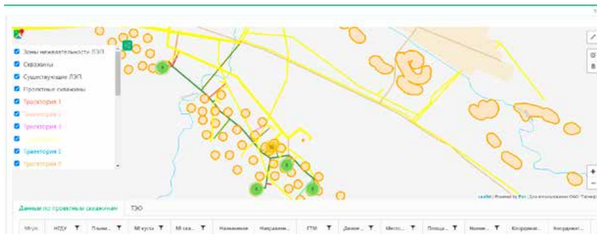
Рис. 3. Автоматически спроектированная линия электропередач
