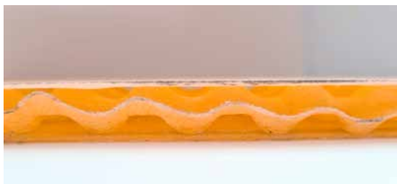
Рис. 7. Многослойная конструкция с ячеистым заполнителем, который изготовлен с применением аддитивных технологий
