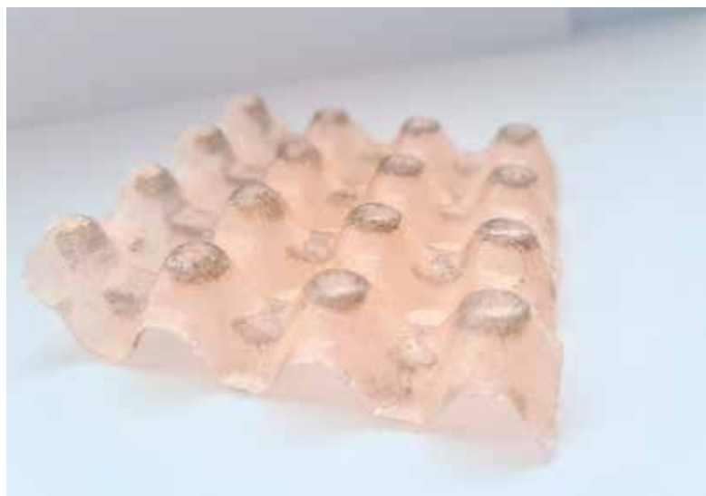
Рис. 3. Первая версия ячеистого наполнителя, изготовленного с применением аддитивных технологий
