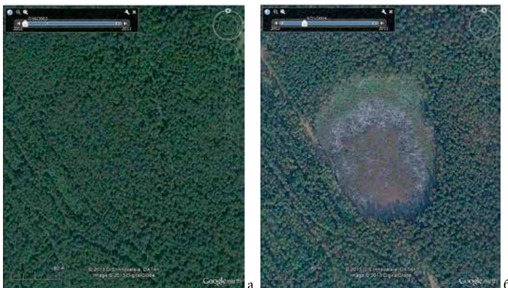
Рис. 1. Снимки одного и того же места в 1,5 км от г. Электросталь. На правом снимке отчетливо дешифрируется заболоченная кольцевая структура проседания. Даты снимков: а) июнь 2002 года, б) сентябрь 2004 г.
