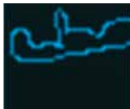
Рис. 2. Построение контура седельного тягача с рис. 1 после фильтрации и бинаризации изображения
