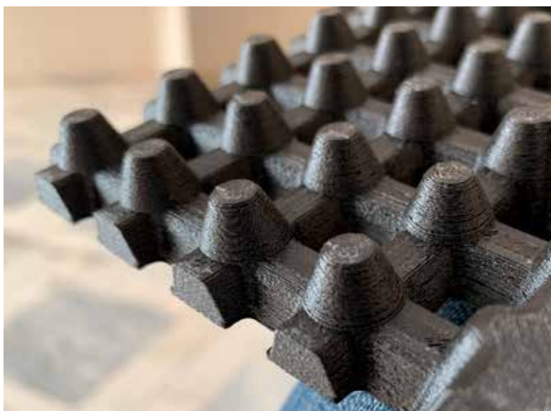
Рис. 4. Средства технического оснащения (форма) из TOTAL GF-30
