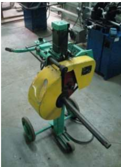
Рис. 7. Подвижный ударно-импульсный гайковёрт с электроприводом (модель IZ30UX14)
