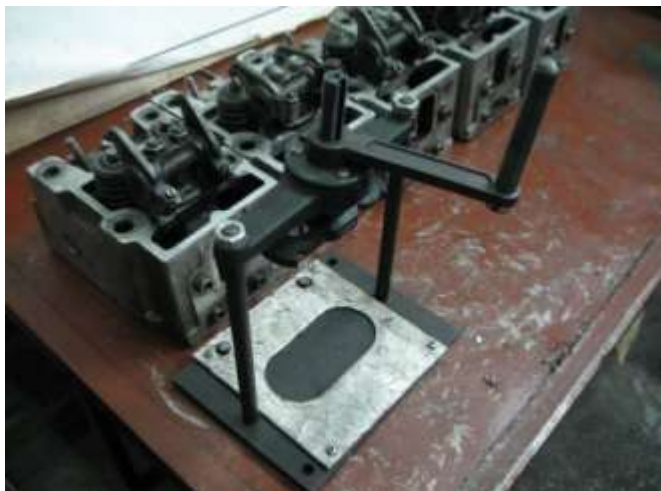
Рис. 8. Съёмник пружин клапанов и головка цилиндра
