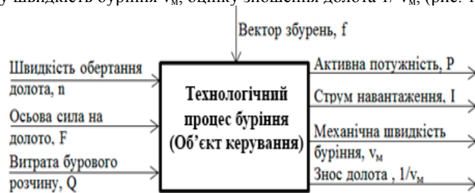
Рисунок 1- Структурна схема технологічного процесу буріння свердловини електробуром
