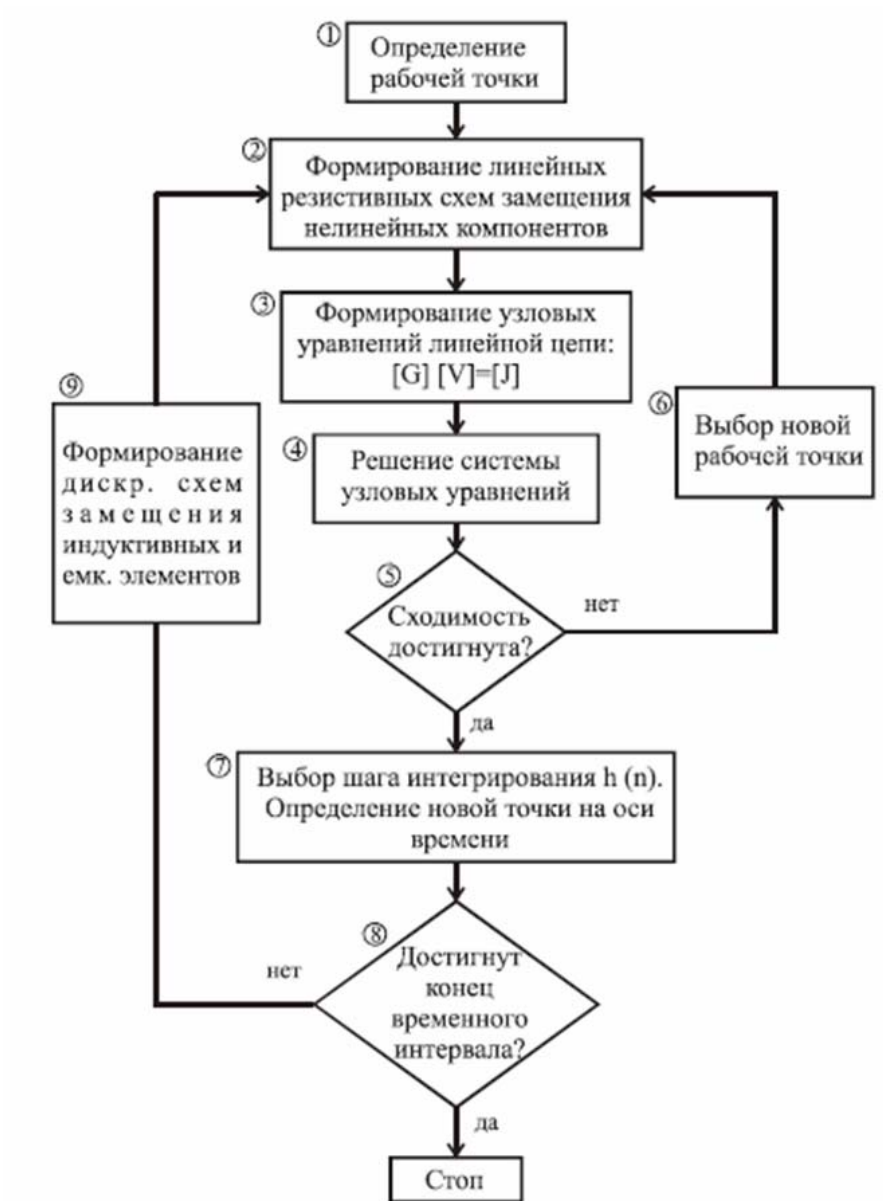
Рис. 9. Блок-схема алгоритма функционирования SPICE
