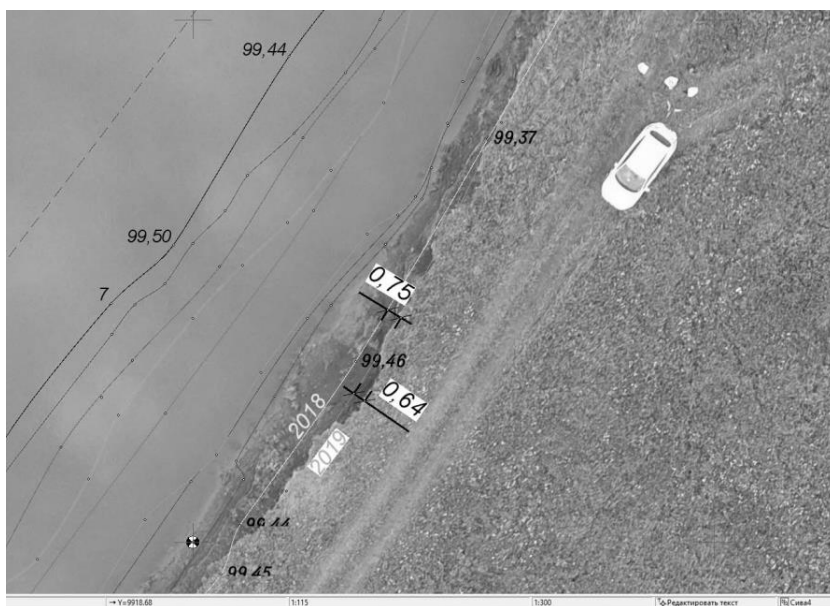
Рис. 2. Выявление неточностей тахеометрической съемки.
