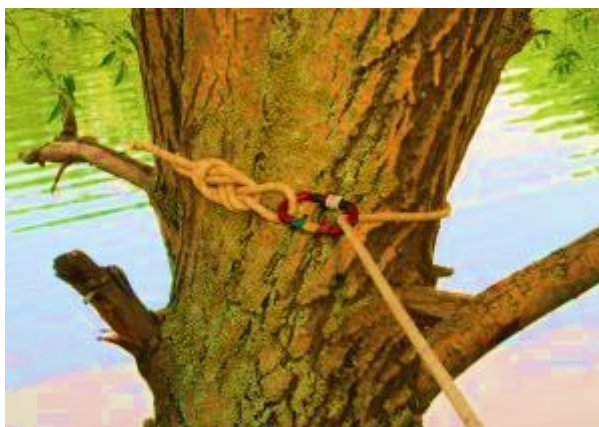
Рис. 2. Способ закрепления веревки на дереве с помощью карабинов
