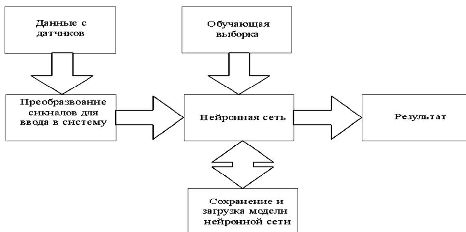
Рисунок 1 – Схема работы виртуального анализатора
