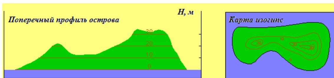
По карте гидроизогипс можно определить направление грунтового потока
