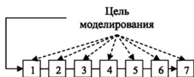
Рисунок 2. Схема имитационного моделирования: 1 – реальная система; 2 – создание логико-математической модели; 3 – разработка алгоритма моделирования; 4 – создание имитационной (машинной) модели; 5 – планирование и проведение имитационных экспериментов; 6 – обработка и анализ результатов; 7 – результаты, связанные с поведением реальной системы (принятие решений)
