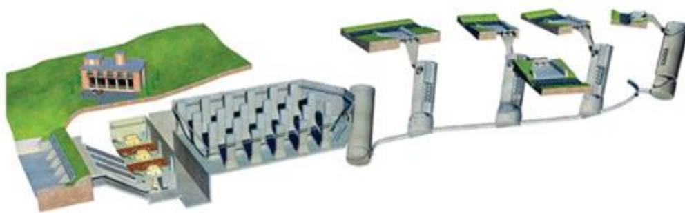
Схема токийского противопаводкового коллектора
