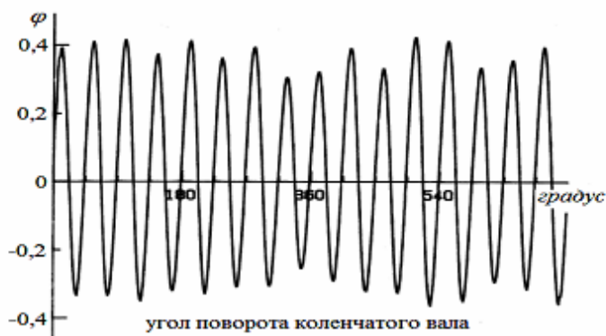
Рисунок 4 м- Одноцикловая временная диаграмма угла закрутки носка коленчатого вала при n=1900 мин -1 , без демпфера крутильных колебаний
