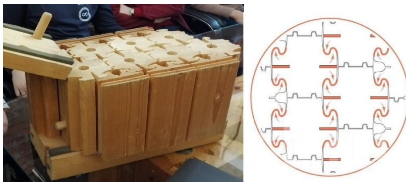
Рис. 1. Макет стеновой конструкции. Соединение шип-паз [1]
