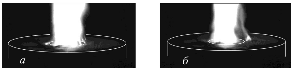
Рис. 5. Мгновенные фотографии прикатодной области плазменного столба. Белыми линиями обозначены очертания пористой пластины. Экспозиция 67 мкс. Интервал между кадрами 125 мс. d = 23 мм. \langle I \rangle = 6 А.
