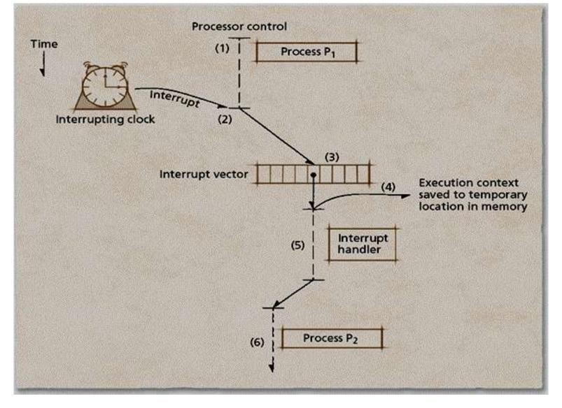
6. Процесс P<sub>2</sub> выполняется на процессоре после загрузки его контекста выполнения
