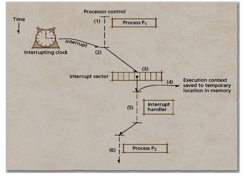
1. Процесс P<sub>1</sub> выполняется на процессоре до поступления сигнала прерывания
