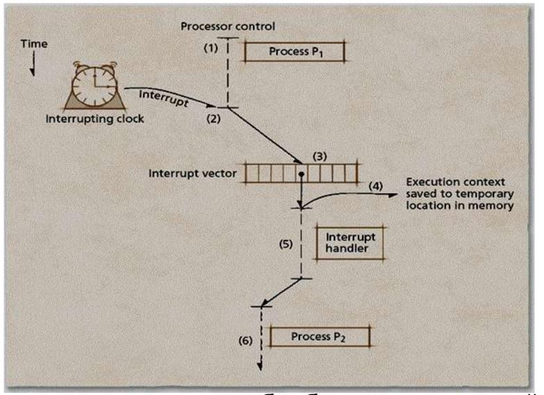
5. Процессор выполняет обработчик прерываний, тот вызывает планировщик процессов, который загружает контекст выполнения процесса  $P_2$  из его PCB из оперативной памяти
