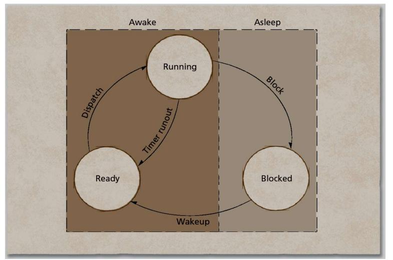
Wakeup – пробуждение; по завершении операции ввода/вывода, ожидаемом процессом, планировщик процессов перемещает указатель на данный процесс из списка заблокированных в за список готовых к выполнению процессов.
