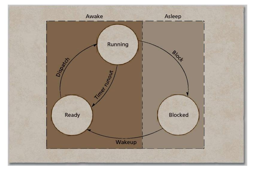
Timer run out – истечение кванта; по истечении кванта планировщик процессов переводит процесс в состояние готовности из состояния выполнения.
