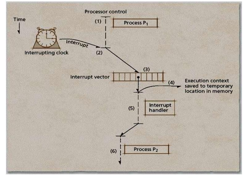
2. Таймер прерываний по истечении кванта времени генерирует прерывание, чтобы исключить захват процессора процессом Р₁
