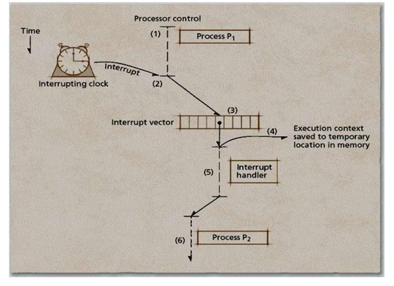
3. Процессор обращается к записи вектора прерываний, соответствующей прерываниям таймера прерываний
