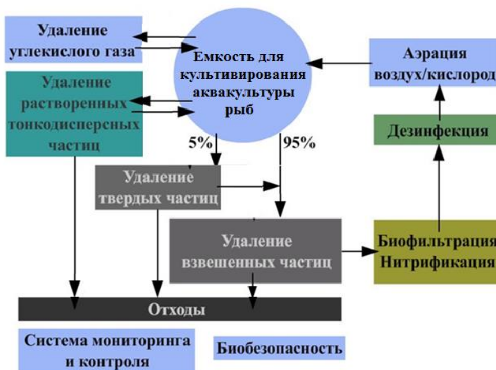
Рисунок 1 – Структурная схема установки для безопасного выращивания рыб в условиях замкнутого водоснабжения
