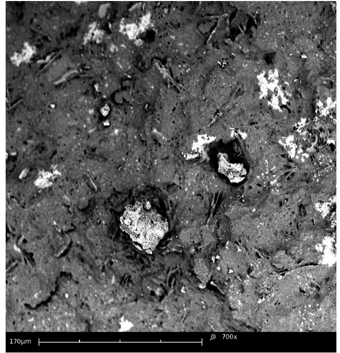
Fig. 9. SEM of hardened AASC4 paste.
