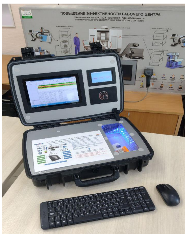
Рис. 2. Мобильный программно-аппаратный комплекс планирования и мониторинга (ПАК ПМ) [3]
