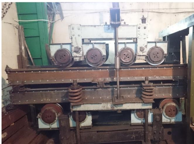
Рис. 3. Стенд для испытаний на выносливость подкрановых балок
