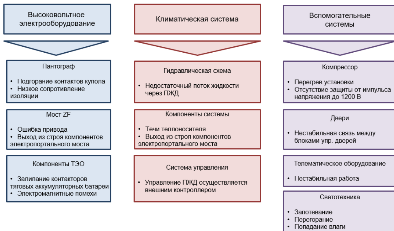
Рис. 2. Выявленные недостатки при эксплуатации электробуса
