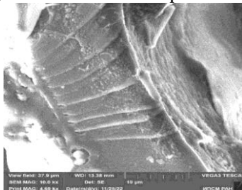
Рис. 2. РЭМ – изображение колонки с МОС (наличие многоступенчатого скола)
