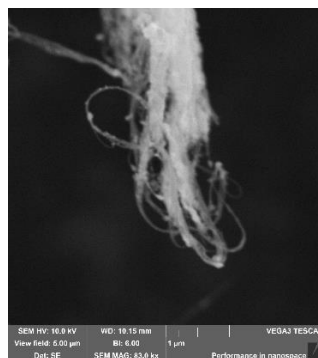
Рис.2. Фотография УНТ1; СЭМ, увеличение 83000 ×
