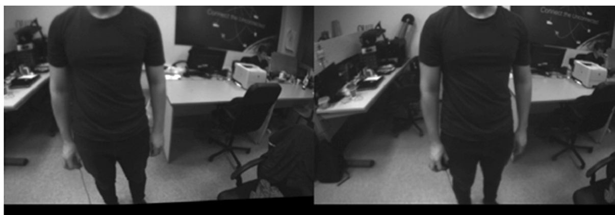
Рис. 8. Кадры, получаемые левой (слева) и правой (справа) камерами СТЗ, составляющими стереопару, после осуществления калибровки стереопары (шаблон №2)
