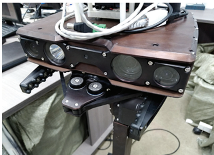
Рис. 1. Голова робота «Сервосила Инженер»: расположение фронтальных камер
