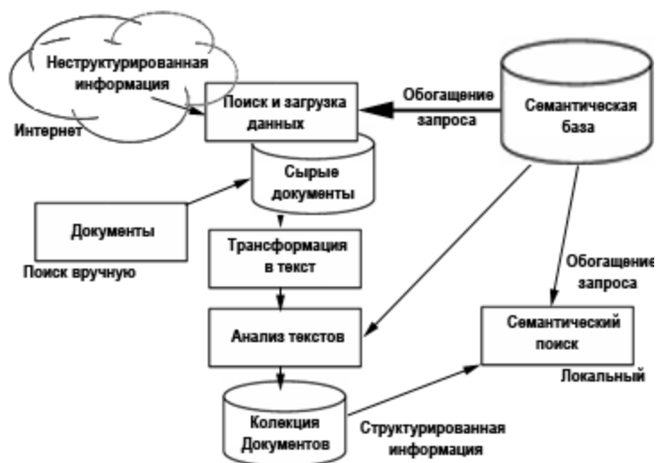
Рис. 3. Программно-технологическая архитектура веб-сервиса для автоматического сбора кинетических и термохимических данных радикальных жидкофазных реакций из открытых оцифрованных источников в Интернете.
