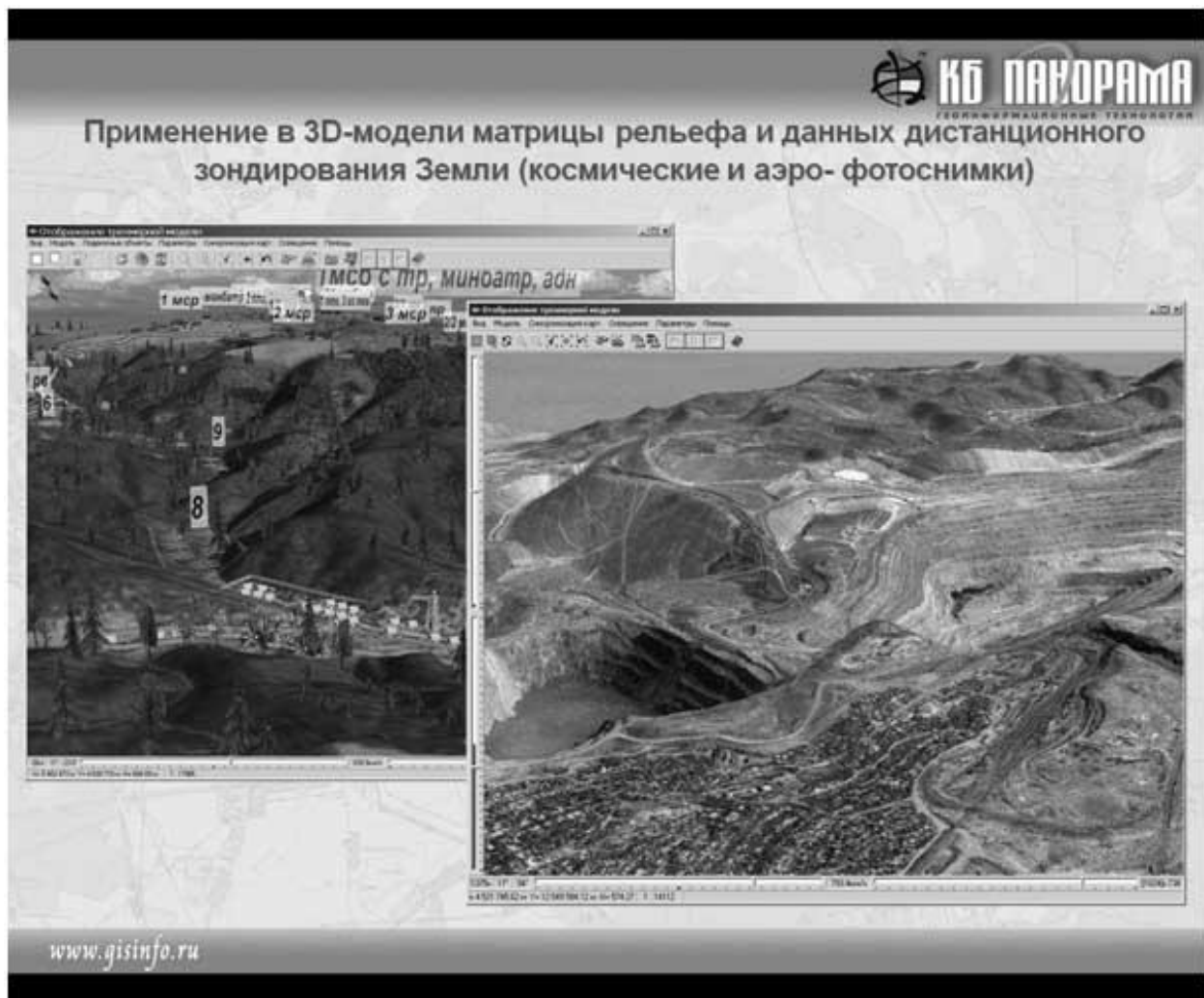
Рис. 1. Применение данных дистанционного зондирования Земли при создании виртуальной модели местности (ГИС «Панорама»)
