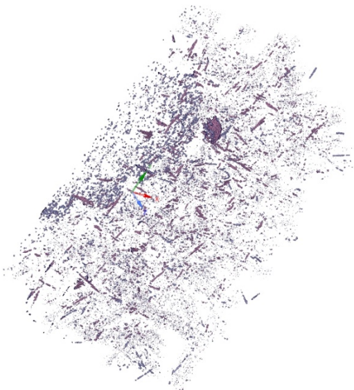
Рис.2. Устранение «шумов» томографического изображения 3D тканого образца в полигональном формате
