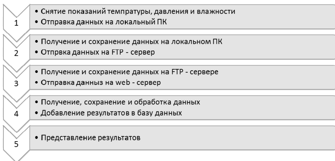
Схема 1. – Общая схема автоматизации сбора информации в системе мониторинга атмосферы.
