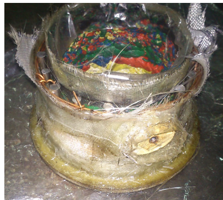
Рисунок 5. – Намотка наружного ротора гибридного электродвигателя.
