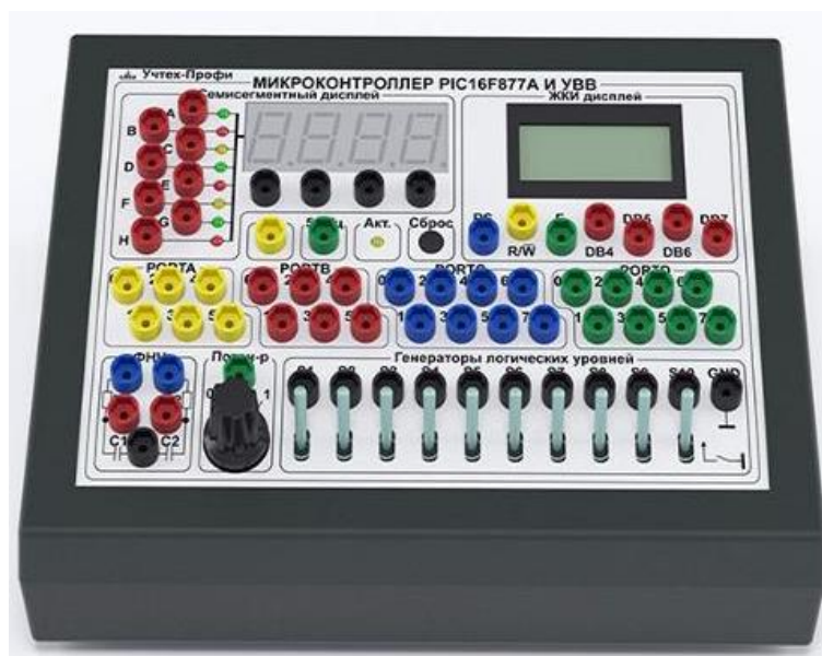
Рисунок 1 – Микроконтроллер PIC16F877A и устройства ввода-вывода
