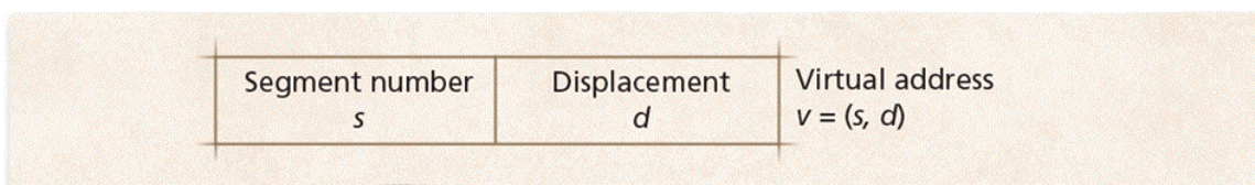
Рис. 12. Формат виртуального адреса в сегментной системе
