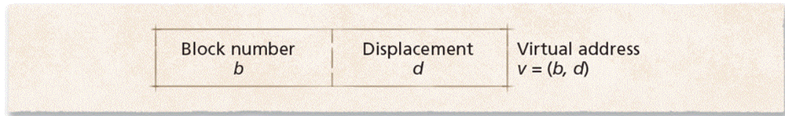
Рис. 4. Формат виртуального адреса в системе с блочным размещением
