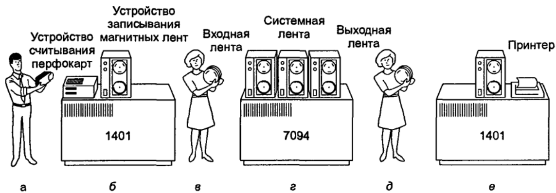
Рис. 3. Ранняя система пакетной обработки: а) программист приносит карты для IBM 1401; б) IBM 1401 записывает пакет заданий на магнитную ленту; в) оператор приносит входные данные на ленте к IBM 7094; г) IBM 7094 загружает компилятор с системной ленты, выполняет вычисления и записывает результат на выходную ленту; д) оператор переносит ленту с выходными данными на IBM 1401; е) IBM 1401 печатает выходные данные.
