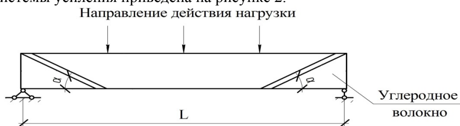
Рисунок 2. – Схема усиления деревянного изгибаемого элемента с использованием углеродного волокна на действие скалывающих напряжений.
