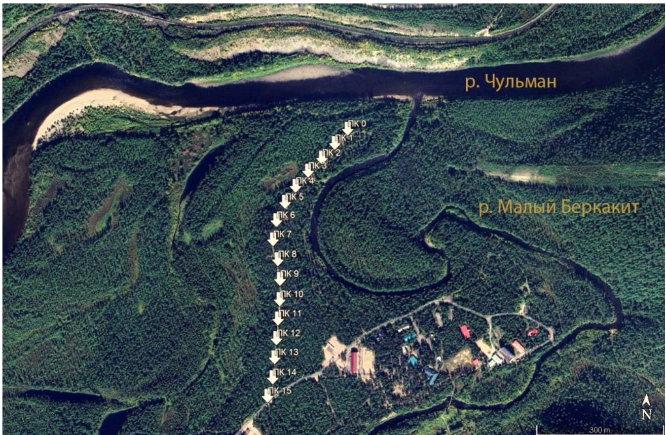
Рис. 1. Космический снимок местоположения геофизического профиля с номерами пикетов в междуречье Чульмана и Малого Беркакита (составлено автором). Длина масштабной линейки 300 м
