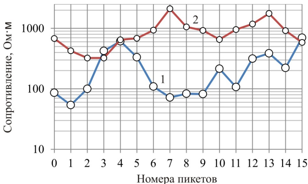
Рис. 2. Графики сопротивления верхней (1) и нижней (2) части массива песчаника (составлено автором)
