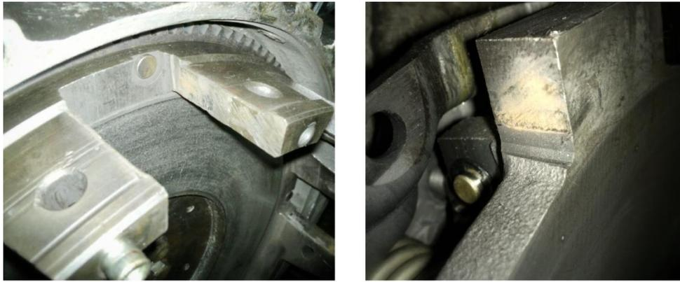
**Рис. 1. Характерные износы пазов маховика и шипов ведущих дисков**
