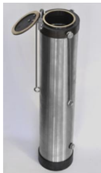
Рисунок 1. Виды батометров: а) Нискина, б) Паталаса.
