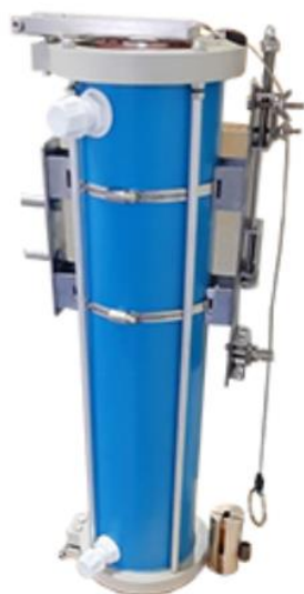
Рисунок 1. Виды батометров: а) Нискина, б) Паталаса.
