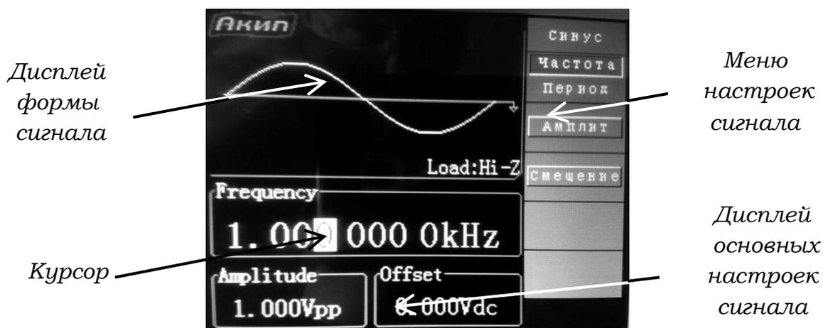
Рис. 5.4. Жидкокристаллический дисплей генератора АКИП-3410/3.
