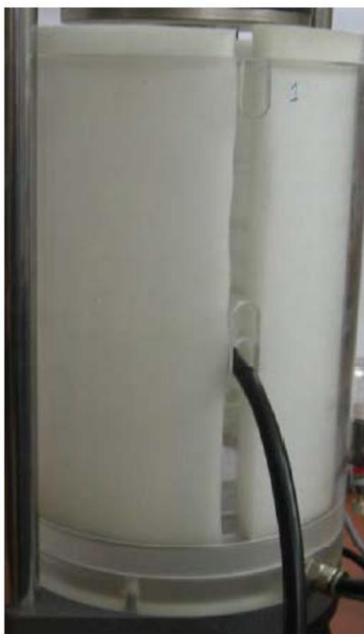
Рис. 7. Теплоизоляционный кожух из пенополиуретана с присоединенным термодатчиком.
