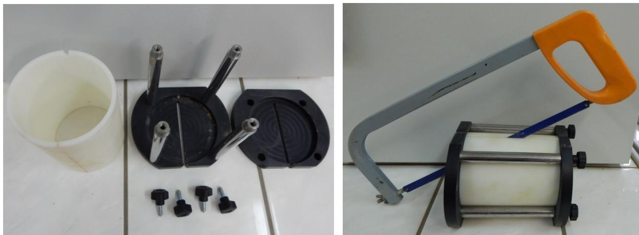
Рис. 13. Контейнер для разрезания образца мерзлого грунта.
