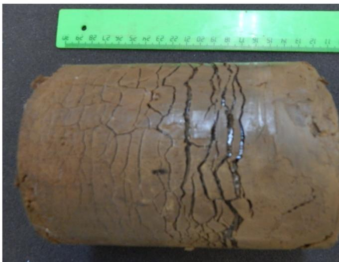
Рис. 12. Измерение фактической толщины промерзшего слоя
