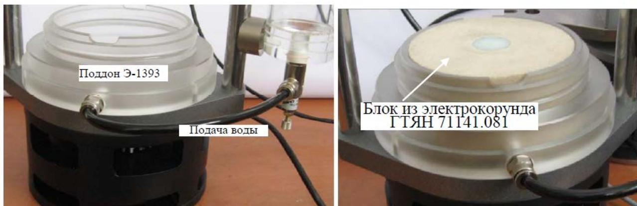
Рис. 4. Нижняя термостатированная плита с поддоном и фильтровальным камнем.
