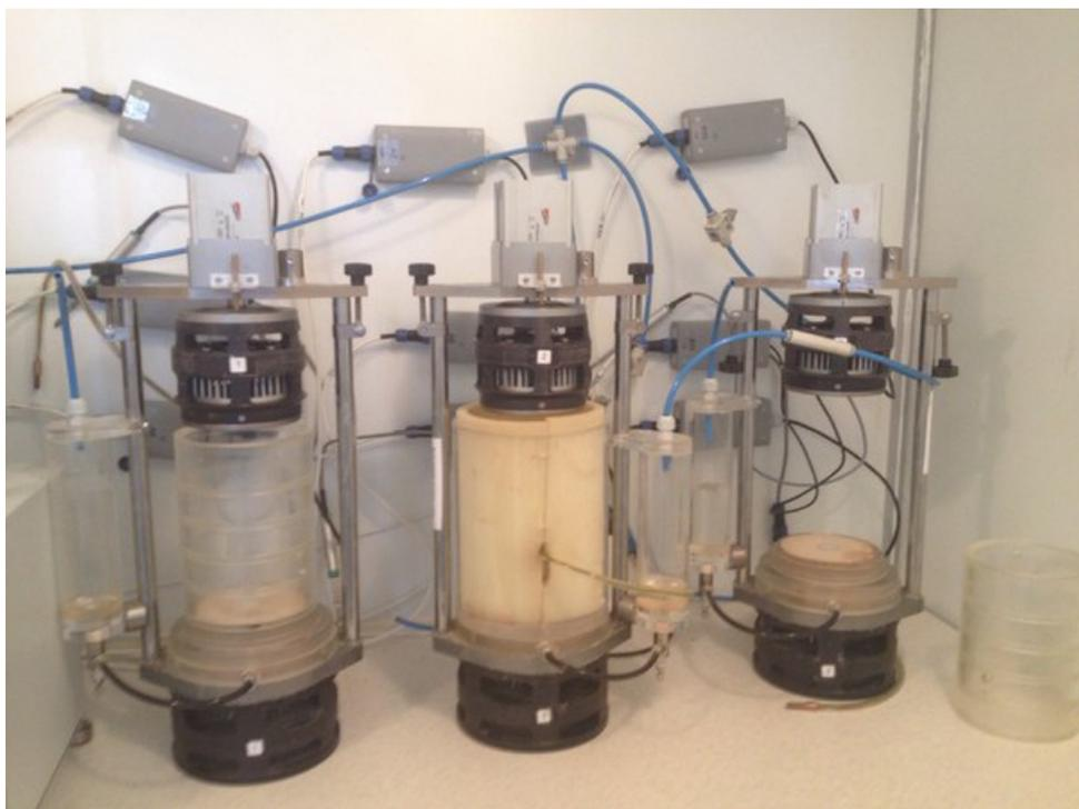
Рис. 2 Общий вид трехпозиционной установка испытания степени пучинистости грунтов в морозильной камере.
