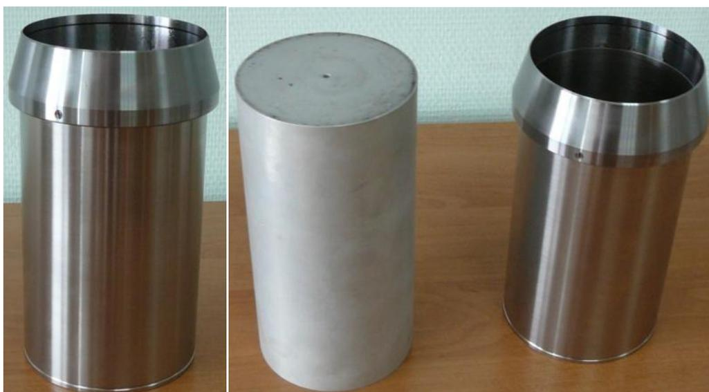
Рис. 5. Режущее кольцо 100 мм и приспособление для выдавливания образца.
