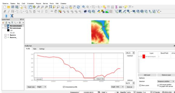
Рис. 2. Построенный профиль рельефа в программе NextGIS QGIS.
