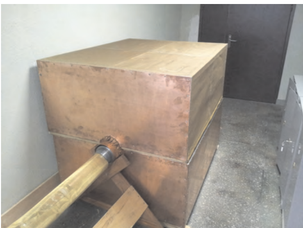
Рис. 3. Малая клетка Фарадея с установленным прибором ЯМК
