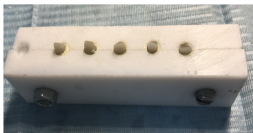
Рис. 12. Изготовление экспериментальных образцов для одной из групп культевых штифтовых конструкций с использованием формы из фторопластового материала.
