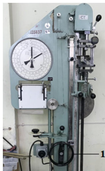
Рис. 14. Разрывная машина ZMGI 250 кр. 1 — рукоятка для нагружения.
