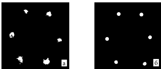
Рис.2. Картины ДМЭ, снятые: после очистки \text{Si}(111) термическим прогревом в два этапа – а; после термического прогрева при T=1500\text{К} \text{Si}(111) , имплантированного ионами Ba^+ с энергией E_0=1\text{кэВ} и дозой облучения D=10^{17}\text{см}^{-2} –б.
