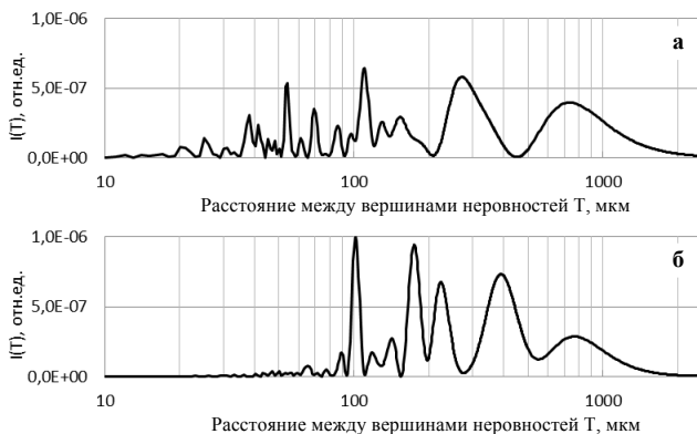
Рис. 4. График распределения плотности расстояний между неровностями профиля внешней поверхности трубчатых образцов
