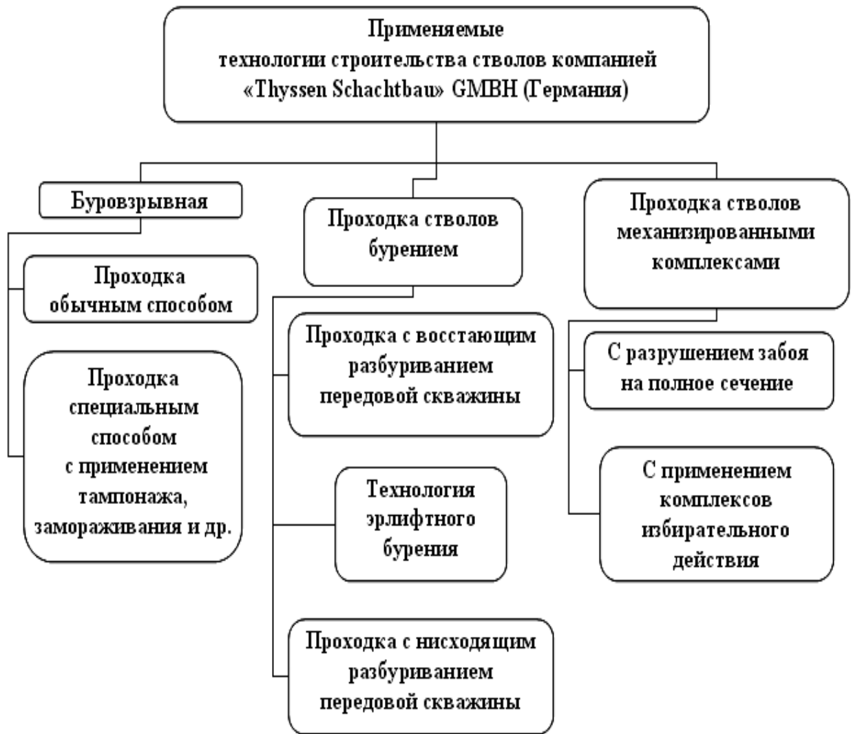
Рис. 1. Применяемые технологии строительства вертикальных стволов компанией «Thyssen Schachtbau»
