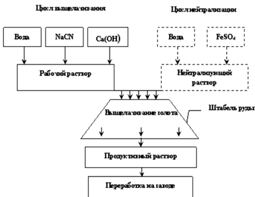
Рис. 2. Принципиальная технологическая схема кучного выщелачивания
