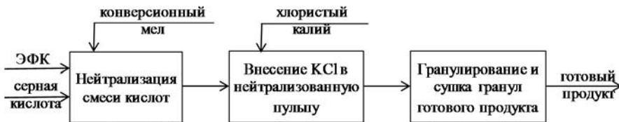
Рис. 1. Блок-схема процесса получения PKS-удобрения
