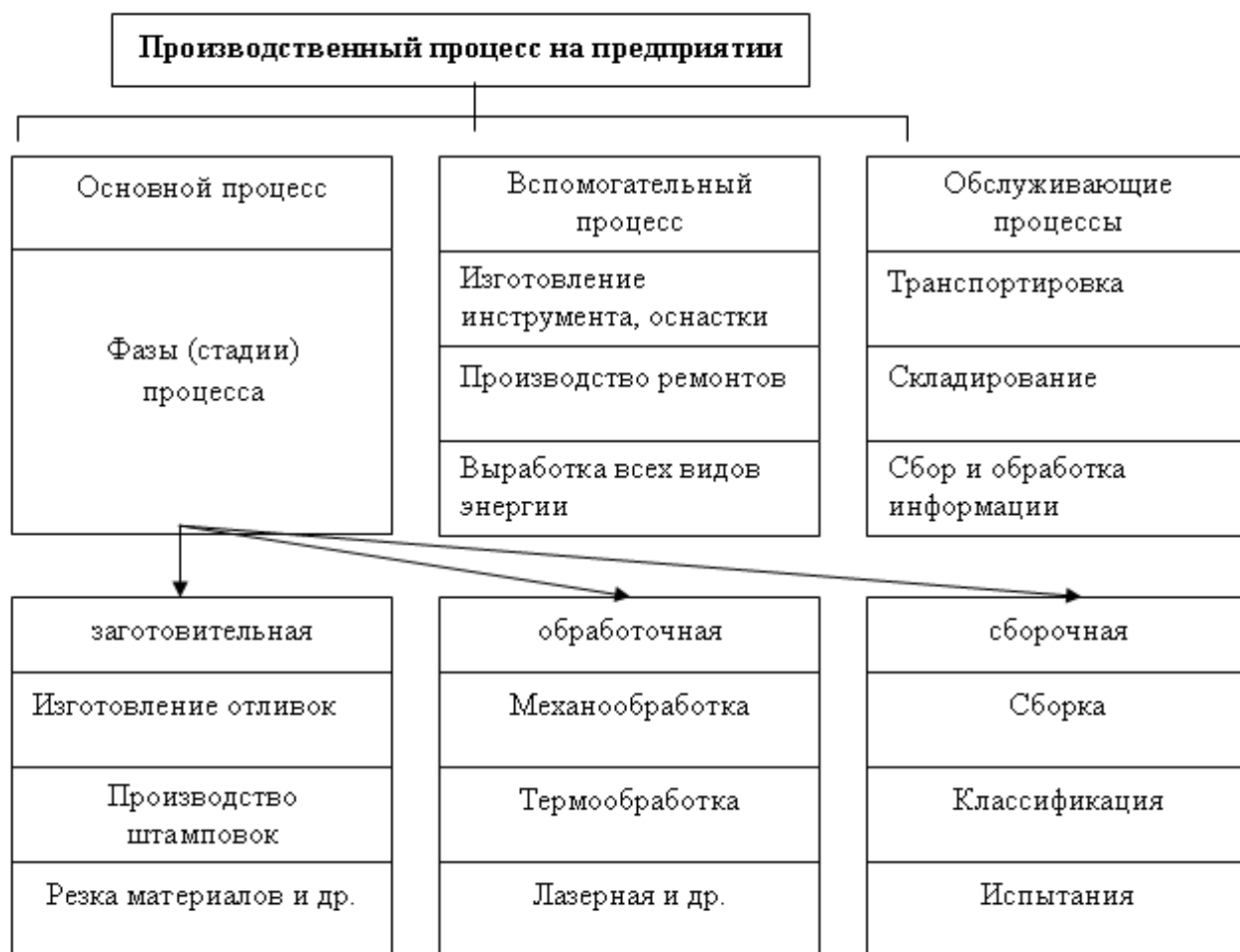
Рис. 7.1. Структура производственного процесса на предприятии
