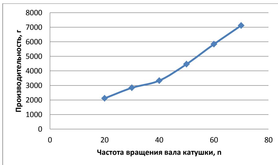
Рис. 3. Подача минеральных удобрений высевальным аппаратом в зависимости от частоты вращения вала катушки
