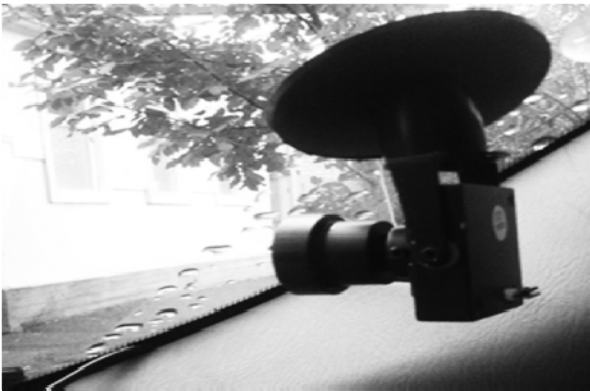
Рис. 2. Размещение камеры видео-фиксации в кабине УАЗ-23632
